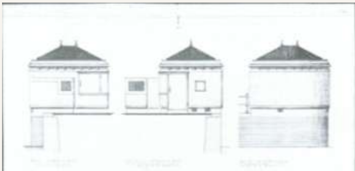
A.A. Kok (Publieke Werken): een van de vijf basistypen transformatorhuisjes (1919) CASA architecten
